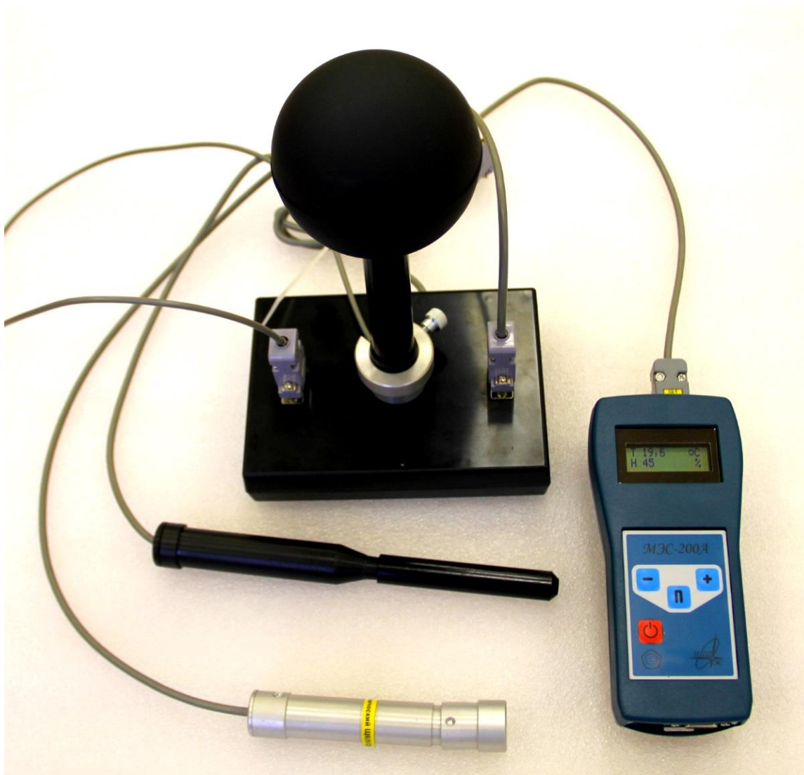
Рисунок 1 – Внешний вид прибора контроля параметров воздушной среды "Метеометр МЭС-200А"
