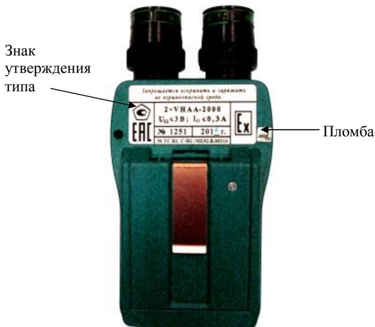
Рисунок 2 – Схема пломбирования корпуса газоанализатора ППА-200 от несанкционированного доступа и место нанесения знака утверждения типа
