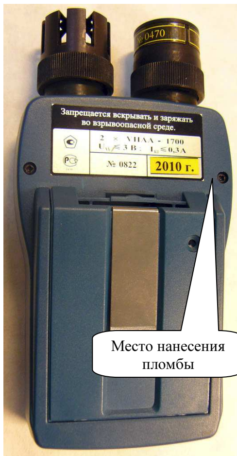
Рисунок 2 – Схема пломбирования газоанализатора от несанкционированного доступа
