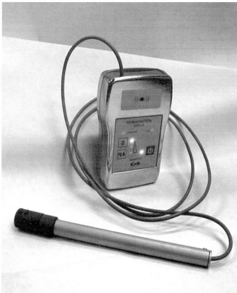
Рисунок – Общий вид течеискателя ТГП-11
